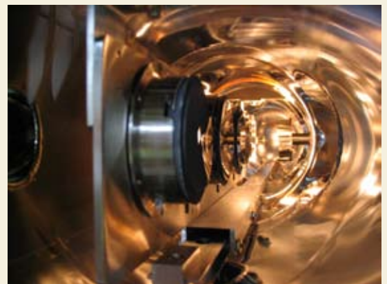
Details aus dem MBE-Labor. Oben: Eine der beiden Epitaxie-Kammern. Unten: Einblick in den Transferkanal.
