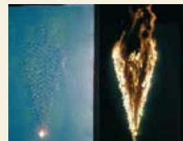
Modellversuch zur unkontrollierten Kettenreaktion (auf eine Metallplatte aufgesteckte Streichhölzer)
