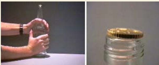
Freihandexperiment zur Ausdehnung von Gasen bei Erwärmung. Der Versuch demonstriert gleichzeitig die Umwandlung thermischer in mechanische Energie.
