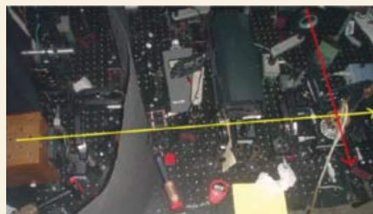
Versuchsaufbau zur Messung von Fluoreszenz, Transmission, Reflexion und Photodegradation.
